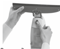
Рисунок 3: Установка насадки для всасывания
