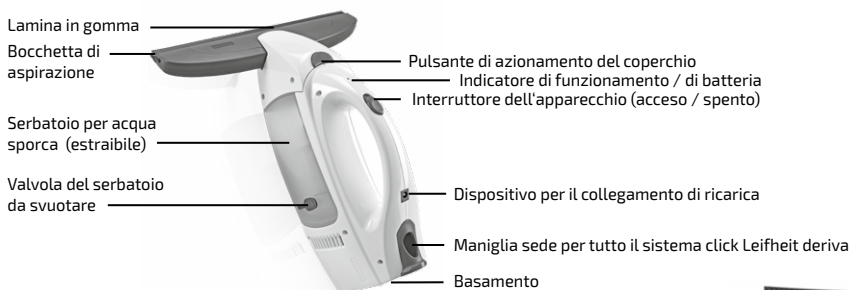
Figura 2: Dispositivi di comando del puliscivetri
