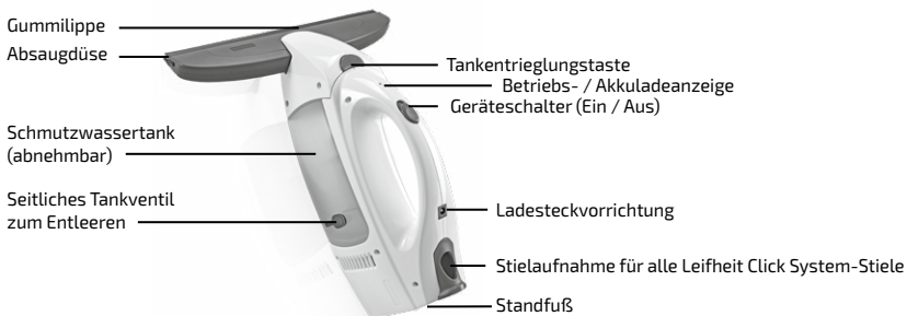
Abbildung 2: Fenstersauger Bedienelemente
