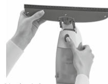
Obrázek 3: Montáž odsávací hubice
