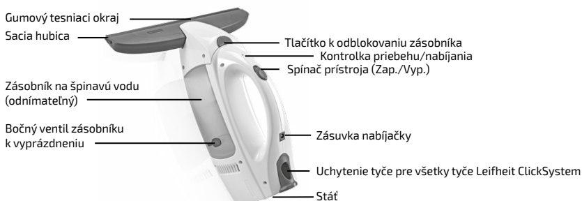
Obrázok 2: Obslužné prvky okennej odsávačky
